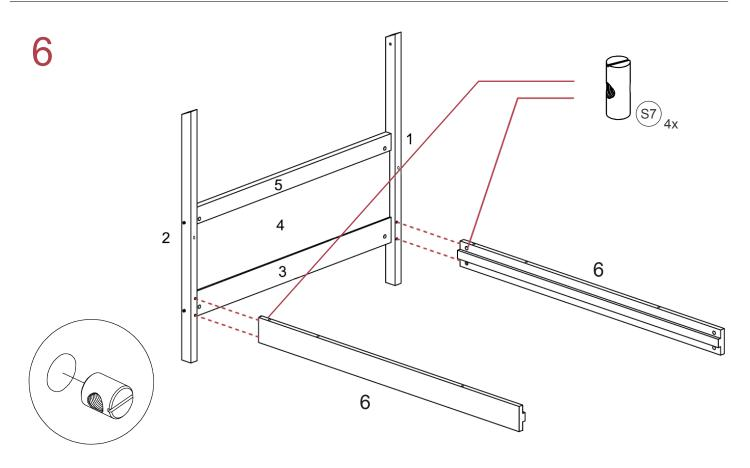
Hinweis: Bitte achten Sie auf die Positionierung der Öffnungen bei Teil 6. Die Löcher sollten nach oben zeigen. Note: Please pay attention to the positioning of the holes on part 6. The holes should point upwards.
