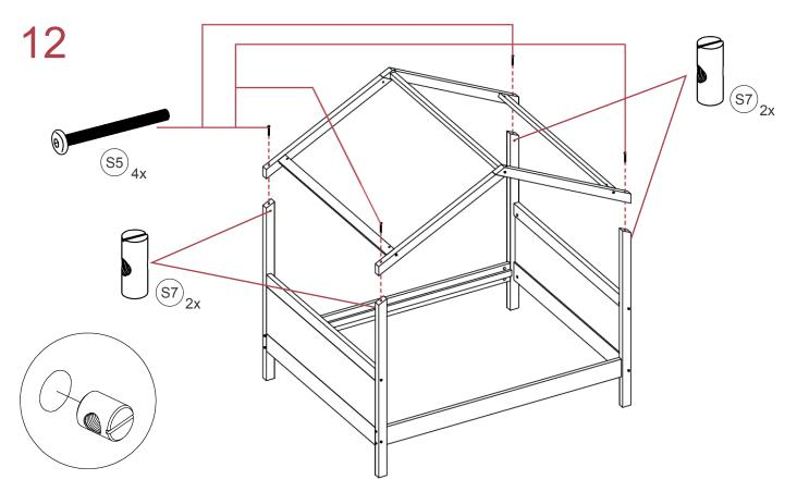
Hinweis: Bevor Sie das Dach fest verschrauben, bringen Sie die Schrauben zunächst locker an. Note: Before you screw the roof tightly, install the screws loosely first.
