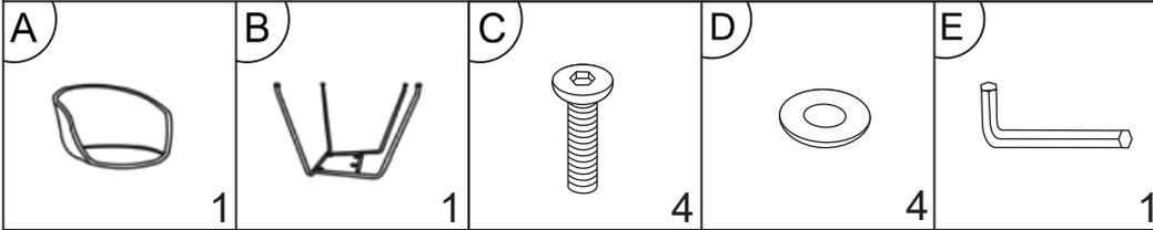
**Schritt 1:** Bereiten Sie die Montage vor, indem Sie das Verpackungsmaterial entfernen und die Sitzfläche (A) umdrehen. Die Montage kann erleichtert werden, wenn Sie die Sitzfläche auf eine Tischkante legen.
