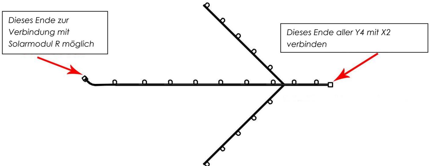
Bitte beachten Sie zudem, dass nur eines der anderen Enden von Y4 dann mit dem Solarmodul R verbunden wird (siehe auch 4.2.10 Schritt 10)
