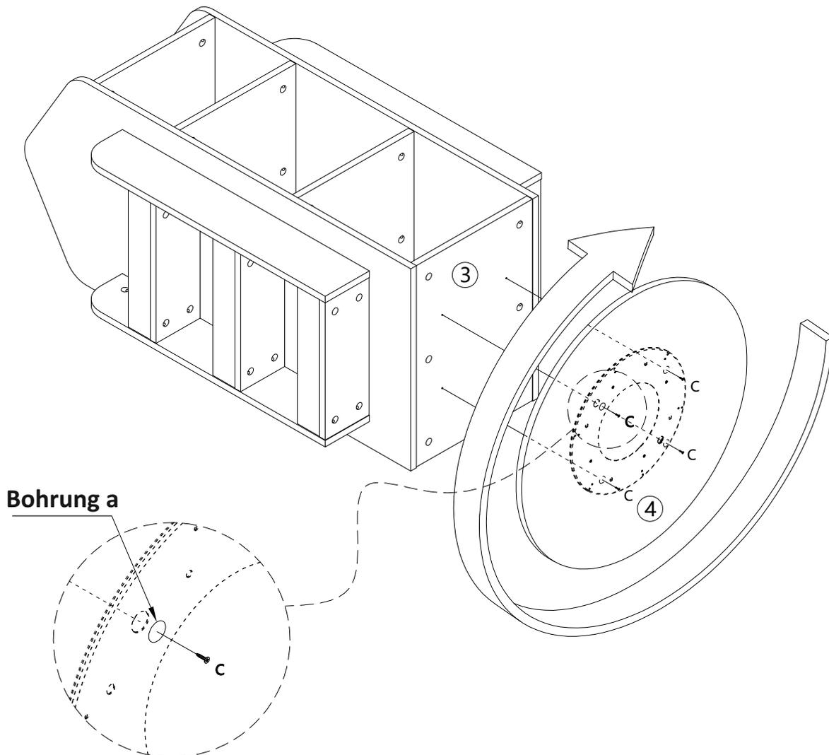
Verwende zunächst die Schraube **C**, um die Teile **4** und **3** durch die Bohrung **a** zu verbinden. Drehe dann Teil **4**, um Bohrung **a** mit den anderen drei Bohrungen auf Teil **3** auszurichten und verbinde dieses mit den Schrauben **C**.
