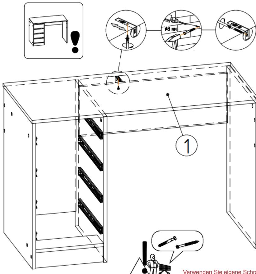
Verwenden Sie eigene Schrauben für die weitere Fixierung des Winkels. Use your own screws for further fixation of the angle.
