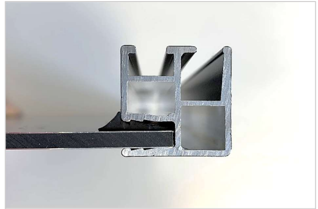
8. Die im Profil montierte Dichtung im Querschnitt
