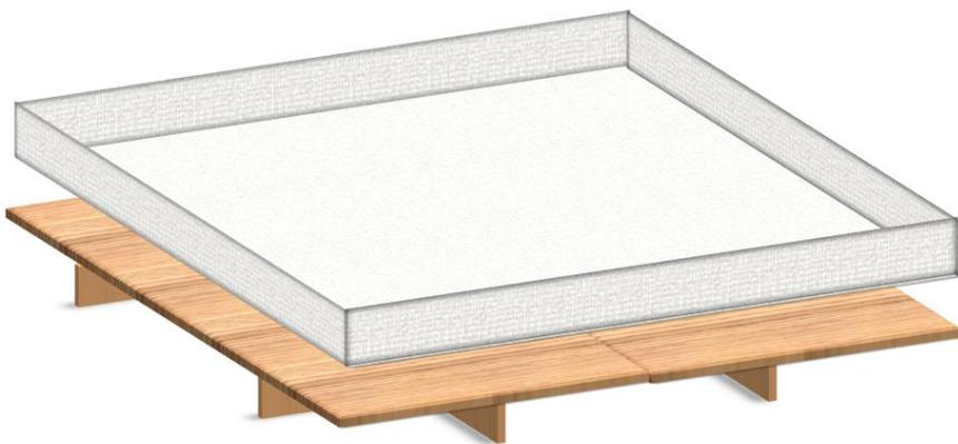
Bettüberzug auf die Bodenplatten auflegen und den oberen Teil abtrennen
