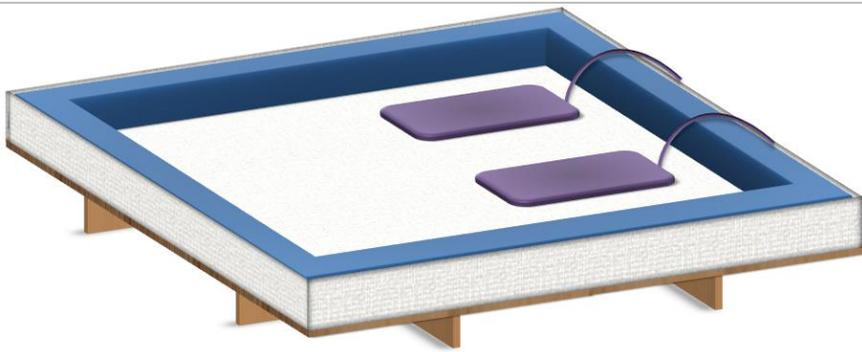
Heizungen positionieren - beim Mono-System in der Mitte des Bettes, beim Dual-System in der Mitte der jeweiligen Seite, etwas in Richtung Fußende verschoben.
