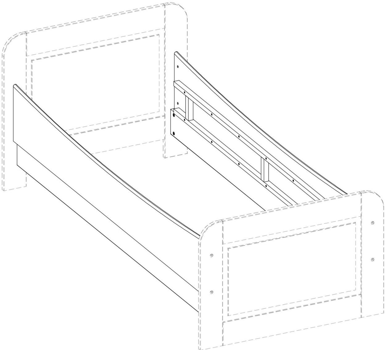
Passend für dieses Bett bieten wir als Zubehör den Bettkasten 90.10-S4, 90.10-S4/2 oder 90.10-S3 an. Bitte beachten Sie, bei Nutzung des Bettkastens darf die unterste Blende des Bettes NICHT montiert werden. Ersatzweise wird dort der Bettkasten eingeschoben.
