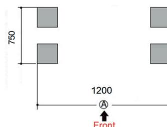
Achten Sie darauf, dass die Fundamentpunkte in der Waage und die Punkte rechtwinkelig ausgerichtet sind!
